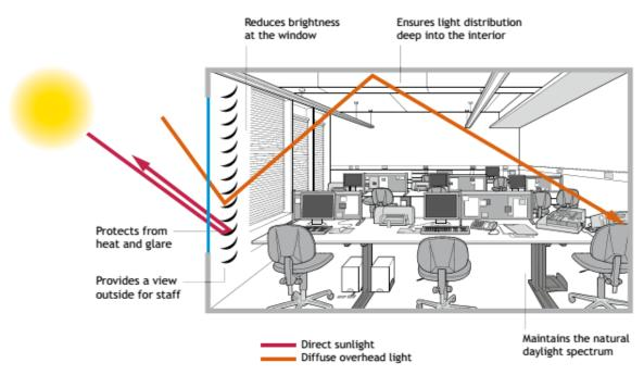
FIG 21: RECOMMENDED DAYLIGHT UTILIZATION SCHEME
