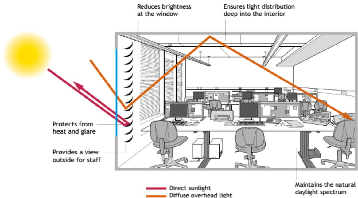
FIG 21: RECOMMENDED DAYLIGHT UTILIZATION SCHEME
